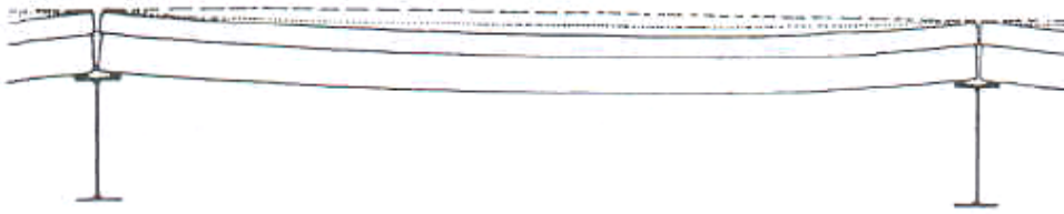
Şekil 8. Isı etkisinin çatıda oluşturduğu hasar [15]
