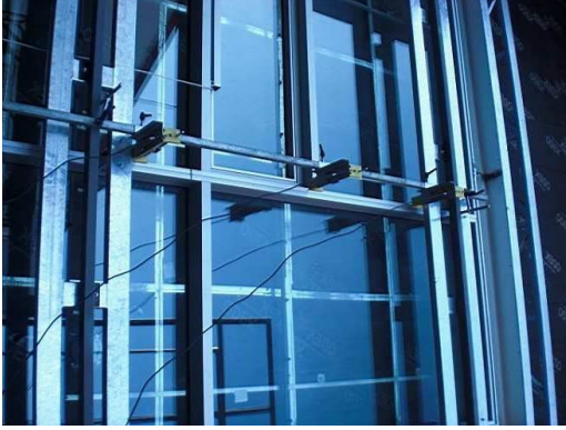
Resim 3 - 4. Su Sızdırmazlık Test Örnekleri: FTİ
