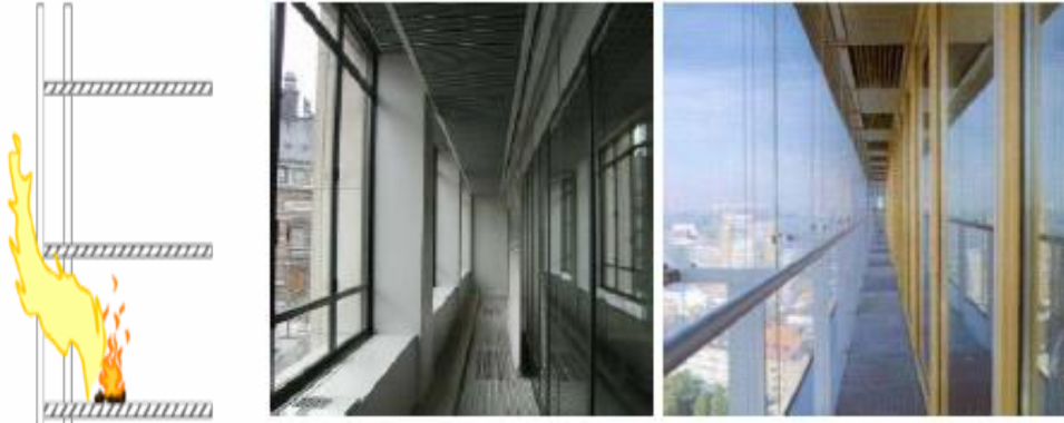
Şekil 9. Kat yüksekliğindeki yangın anındaki alevin yayılma davranışı (a) ve cepheler (b) [16]
