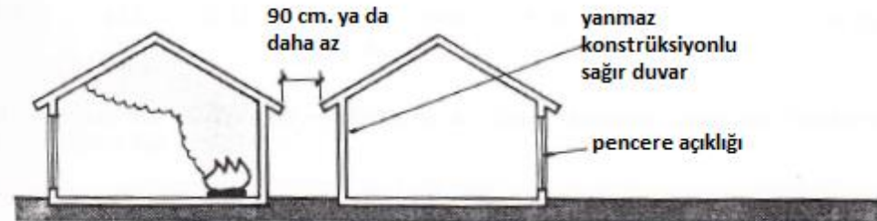
Şekil 11. Komşu binalar arasında Yangının yayılmasının engellenmesi [10].
