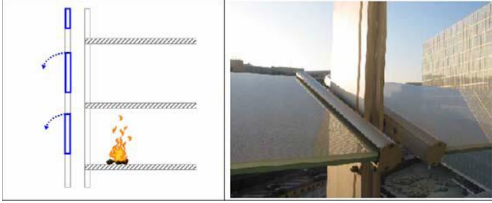
Şekil 4a ve 4b. Yangın sırasında yatık konuma getirilen jalûziler [16]
