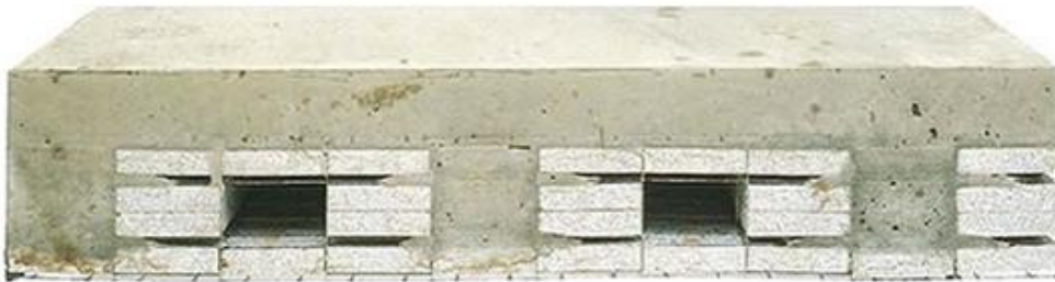
Şekil 4. Betonlanmış döşeme panelinin kesiti [5]
