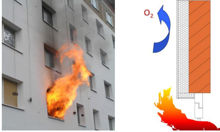
Şekil 2a ve 2b. Alev ve dumanın mantolama cephe boyunca hareketi [15]
