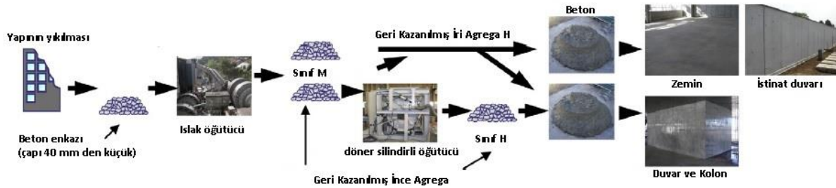
Resim-5 GKB'nun üretilme süreci,[47]
