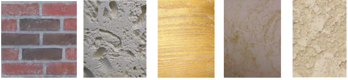
Şekil 1. 4. GFRP panellerin yüzey renk ve dokuları
